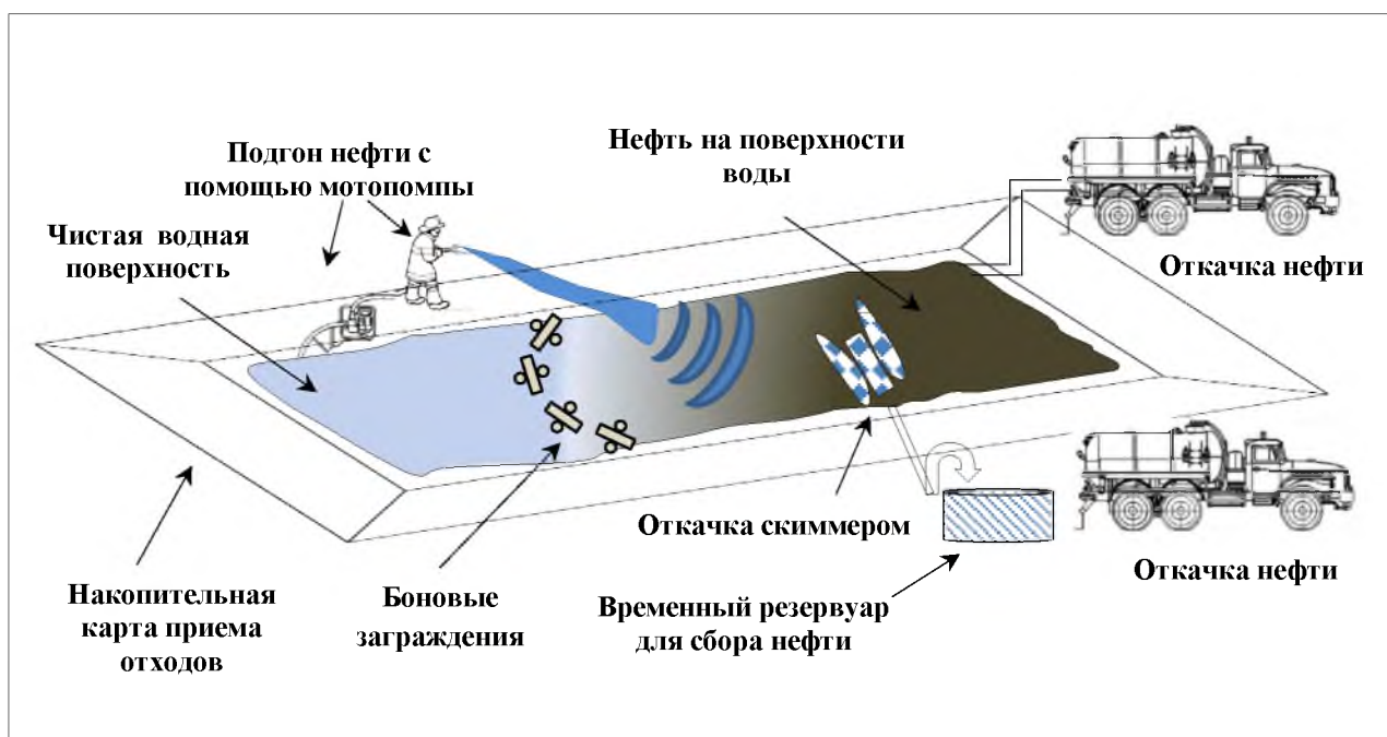
Рисунок № 13. Методы и технологические приемы при сборе свободно плавающей нефти и нефтепродуктов в карте шламонакопителя
